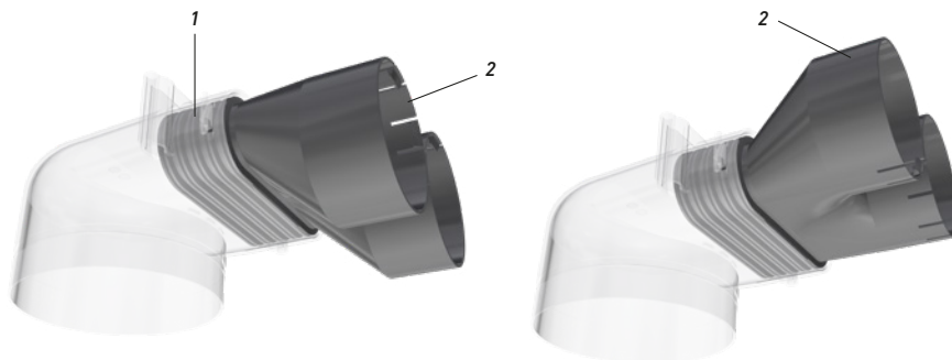
1 KomFlex® Anschluss mit Zugsicherung 2 Anschluss wahlweise um 180° verdrehbar
